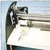
Particolari del sistema di stampa. Nella e due gestioni (quella di destra è regolabile a seconda delle dimensioni del foglio) e il ricalco magnetico che alza e abbassa la penna.
